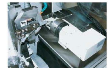
Шліфування інструментів з використанням поворотної осі та ЧПК
