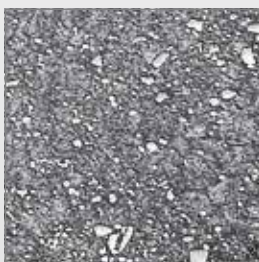
Структура матеріала кромки зубів (M42 HSS)
